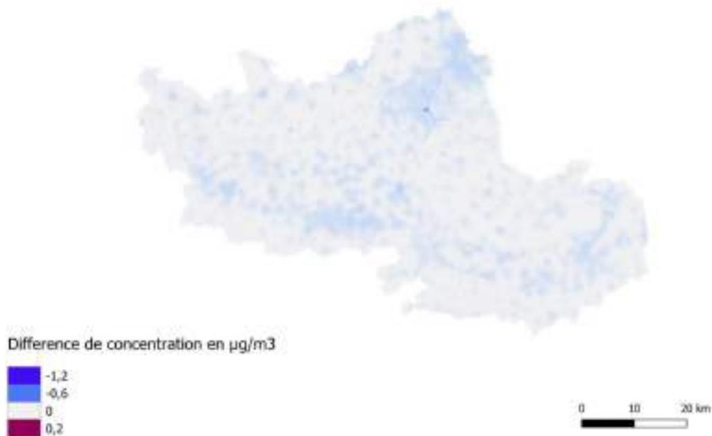
Figure 37 : Différence des concentrations en  $\text{PM}_{2,5}$  entre les deux scénarii à l'horizon 2027
